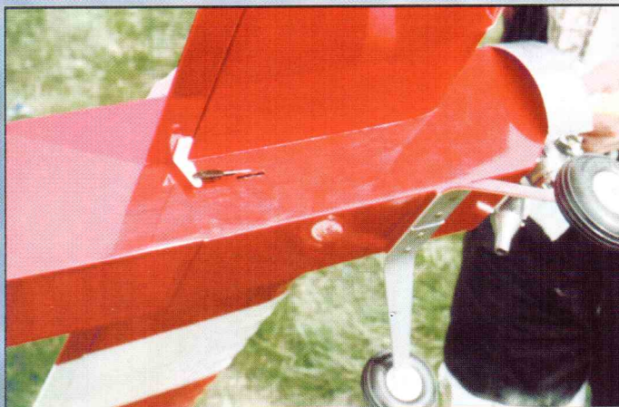
Носовая часть модели, вид снизу. Крепление стоек шасси и привод элеронов первой модификации.
