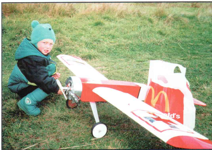
Вторая модификация «Фоккера». Новое шасси, «полотно» на крыле, машинка газа поставлена над двигателем.
