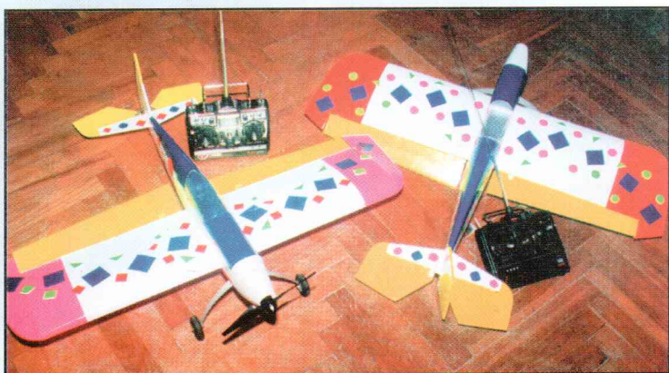
Эти модели, класса Fan-Fly, Игоря Берекета из Кишинева, созданы по английским чертежам, имеют вес 900 г и снабжены двигателем ЦСТКАМ-2,5. Используется пятиканальная аппаратура.
