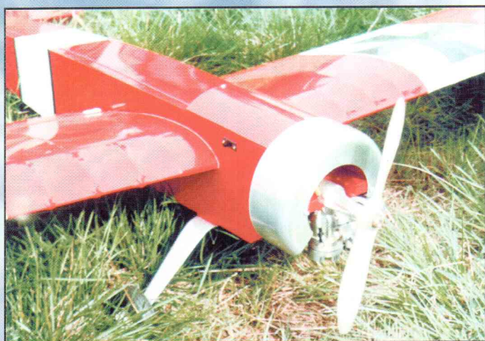
Выключатель питания бортовой части аппаратуры расположен в удобном месте на правом борту фюзеляжа.
