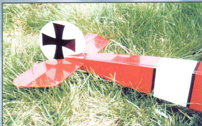
Хвостовая часть модели. Антенна проведена сверху фюзеляжа и оттянута резиновой петлей.
