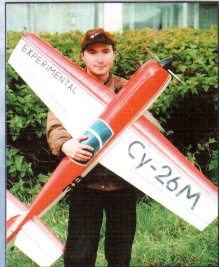
Алексей Мастюгин с любительской копией Су-26М. Размах модели 1600 мм, вес 3500 г, двигатель рабочим объемом 10 см 3 .
