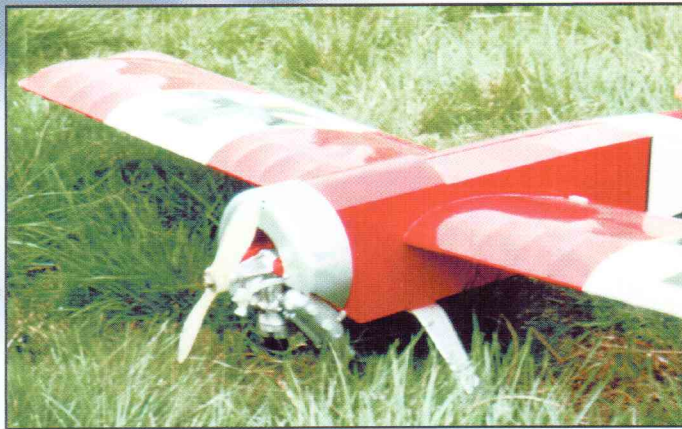
Из-за большого поперечного сечения фюзеляжа глушитель пришлось ставить на переходник, с большим выкосом вниз.
