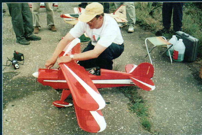
Ещё один дебютант соревнований 2004 года, авиамоделист из г. Перми Роман Плетнёв, регулирует работу мотора на красивой копии американского пилотажного биплана «Стин Скайболт». Размах крыльев модели 1820 мм, двигатель OS MAX 90 FS.
