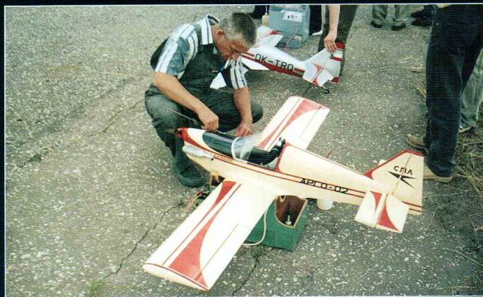
Дебютант Чемпионата 2004 года спортсмен из г. Владимира, Сергей Кузьмин готовит к полёту в туре новенький, симпатичный «Арго-02» собственного изготовления. Размах крыла 1800 мм, вес 4100 грамм, двигатель «Мастер 61», воздушный винт углепластиковый типа APC 330×200 мм.
