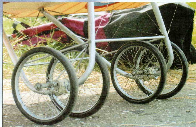
Узел шасси «Сикорского» крупным планом. Все элементы были изготовлены вручную (включая обода и спицы) самим спортсменом. Вся конструкция полностью идентична прототипу. Изумительная работа!
