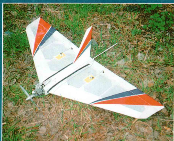
Модель «летающее крыло» разработки 2000 года, применяется местными моделистами как радиобойцовка. Скоростной и маневренный аппарат. Размах крыла 1100 мм, вес 950 г, мотор 3,5 см 3 .
