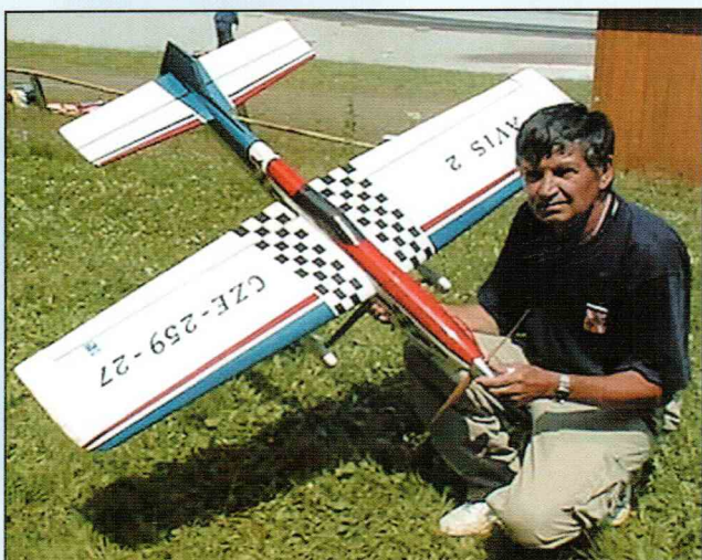
Спортсмен Zdenek Krizka из Чехии с самодельным акробатом бальзовой конструкции в котором соблюдены пропорции чешской школы кордовых пилотажек.
