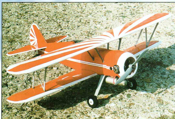
Стильная копия пилотажной модификации биплана PT-17 Super-Stearman собрана из набора фирмы Kyosho Александром Скирдаковым. При размахе 1260 мм с двигателем Irvine-.53 этот аэроплан весит 2700 г.
