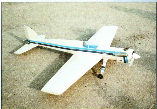
Необычен дизайн любительской пилотажной модели, которую сконструировал и построил С.Корсаков. Размах крыла этого самолета равен 1600 мм. С двигателем МДС-78 модель весит 3200 г.
