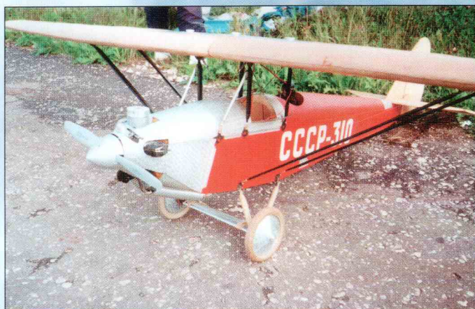
Модель-копия АИР-3 бронзового призера соревнований, спортсмена из г. Екатеринбурга Евгения Светлова. Размах крыла 2700 мм, вес 6200 г, двигатель OS MAX.
