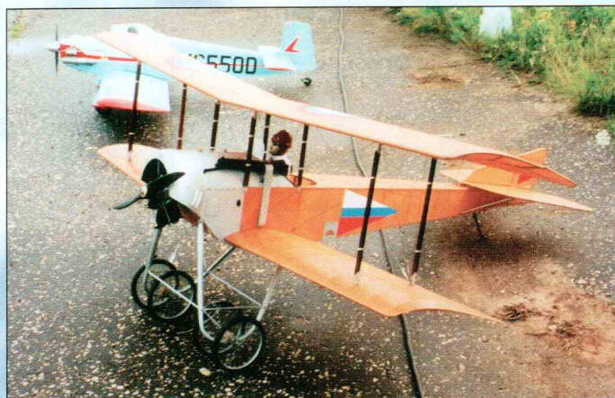
Модель Сикорский С-ХVI, Чемпиона России 2003 года Александра Петухова (г. Новосибирск) на стояночной линейке. Размах крыла составляет 2100 мм, вес 6500 г, двигатель «Мрия» 25 см 3 .
