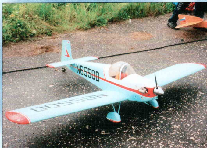
Модель-копия любительского самолета «Turbulent» с которой выступал спортсмен из г. Ярославля Алексей Герасимов, занявший 5 место. Размах крыла 2070 мм, вес 5400 г, двигатель OS MAX 91 Ring.
