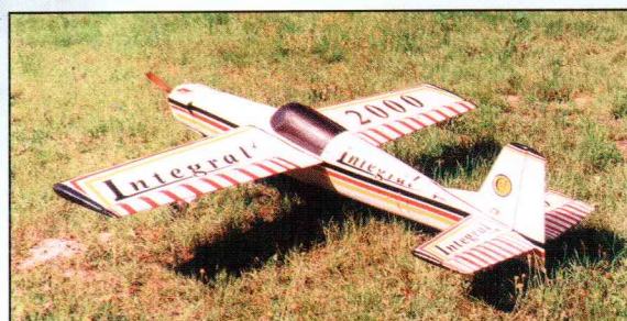
Пилотажный самолет Integral-2000 — совместная разработка Гращенкова и Малкова. Размах 2200 мм, длина 1800 мм, вес 6200 г, двигатель Super Tigre G-2500 (25 см 3 ). Используется самодельный деревянный воздушный винт 360x180 мм, изготовленный в соответствии с лучшими западными образцами. Необычный капот эффектной формы выклеен из стеклопластика.
