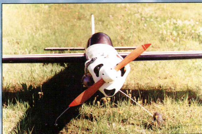
Пилотажный самолет Integral-2000 — совместная разработка Гращенкова и Малкова. Размах 2200 мм, длина 1800 мм, вес 6200 г, двигатель Super Tigre G-2500 (25 см 3 ). Используется самодельный деревянный воздушный винт 360x180 мм, изготовленный в соответствии с лучшими западными образцами. Необычный капот эффектной формы выклеен из стеклопластика.
