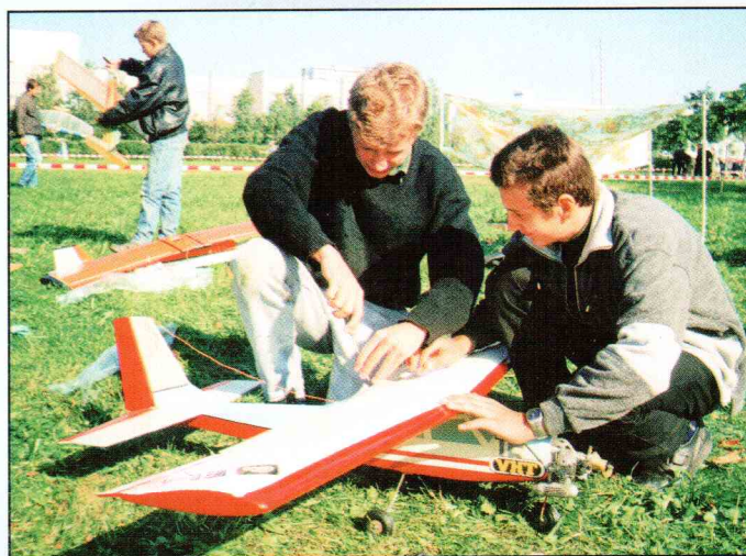
Модель верхнеплана построена по чертежам MAXI (Graupner) Игорем Радченко (на снимке слева). Исходная конструкция сильно модифицирована. Размах крыла 1700 мм, длина 1200 мм, мотор рабочим объемом 6,5 см 3 . Масса модели равна 2600 г.
