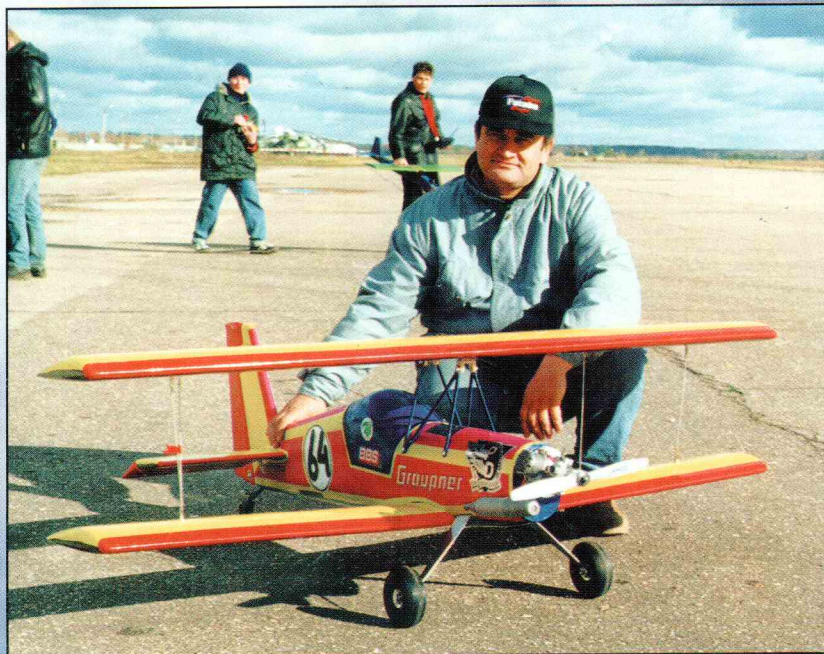
Директор СЮТ подмосковного Одинцово Александр Гращенков с RC бипланом собственной конструкции. Размах крыльев 1800 мм, длина модели 1600 мм, вес 5600 г. Двигатель OS MAX 91 FSR (15 см 3 ) оснащен винтом 320x150 мм. Задействовано пять каналов управления.
