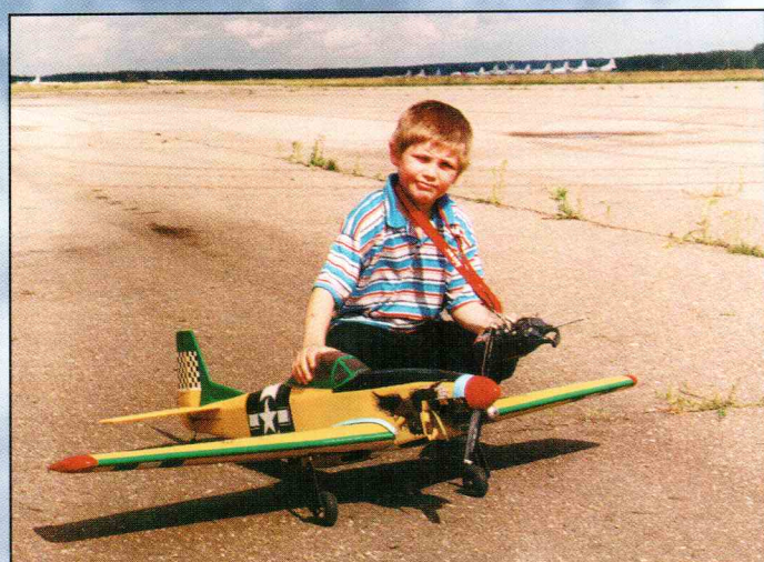
Еще одна копия «Мустанга», и также самостоятельного изготовления. Ее построил Марат Рахманов. Размах 1600 мм, вес 3200 г, двигатель OS MAX 40-FX. Винт 270x150 мм. На снимке рядом с моделью — сын Марата, которому иногда доверяют пилотировать эту копию.
