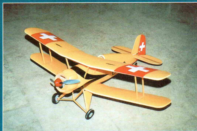
Копия Bu-131 «Jungmeister» — электролет класса Slow flyer фирмы Robbe. Размах крыла составляет 790 мм, масса около 300 г; мотоустановка — электродвигатель Mabuchi 280, оснащенный одноступенчатым зубчатым редуктором 4:1.
