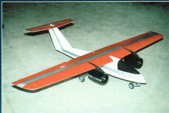
Оригинальная модель Cometa от фирмы Graupner. Этот самолет оснащен двумя импеллерными установками с электродвигателями Kyosho BL29, а также трехстоечным шасси с газовыми амортизаторами. Размах крыла модели составляет 1270 мм, масса до 2100 г.
