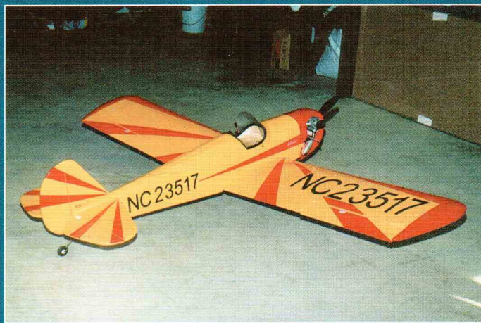
Радиуправляемая полукопия любительского самолета Space Walker, выпускаемая в виде набора ARF японской фирмой Kyosho. Модель оборудована четырехтактным двигателем OS Max 52 FS, имеет размах крыла 1580 мм, весит до 2700 г.
