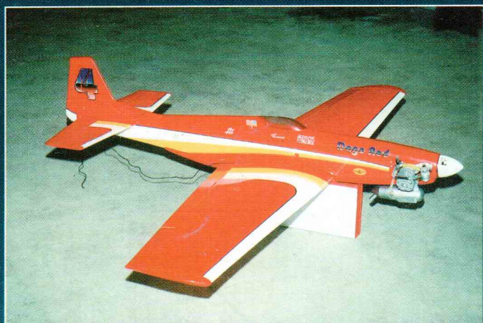
Полукопия истребителя Mustang P-51B, принимавшего (под названием Dago Red) участие в авиационных гонках. Модель собрана из набора ARF-готовности фирмы Kyosho. Размах крыла 1180 мм, вес около 1400 г, установлен двигатель OS Max 25 FX.
