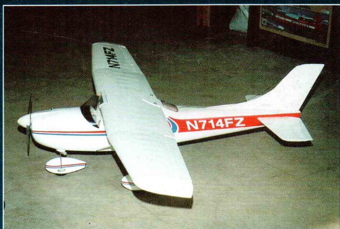
Полукопия легкомоторного американского самолета Cessna-182 SkyLane-II. Модель собрана из ARF-набора японской фирмы Kyosho и оснащена микродвигателем OS MAX .46-LA. Размах крыла составляет 1580 мм, масса модели — около 2500 г.
