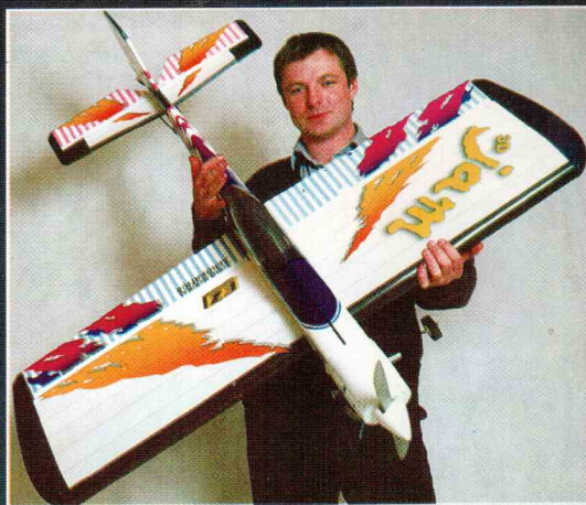
Олег Бабич представляет японскую модель оригинальной конструкции Jam-3D. Несмотря на пилотажный дизайн, по летным характеристикам Jam-3D относится к «фан-фляям». Размах крыла 1600 мм, масса до 2500 г, двигатель 6,5—8 см 3 . Поставляется в виде ARF-посылки.
