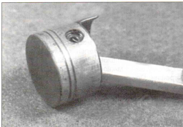
Доработанный поршень. Хорошо виден конус, снятый у кромки доньшка с боковой поверхности. Пропилены две маслоудерживающие кольцевые канавки.
