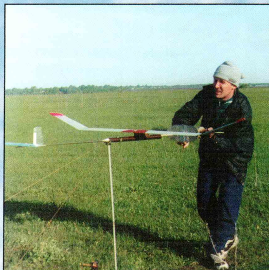
Завершающая стадия закрутки резинодвигателя. Максим Солодов из Санкт-Петербурга станет пятым на втором этапе.
