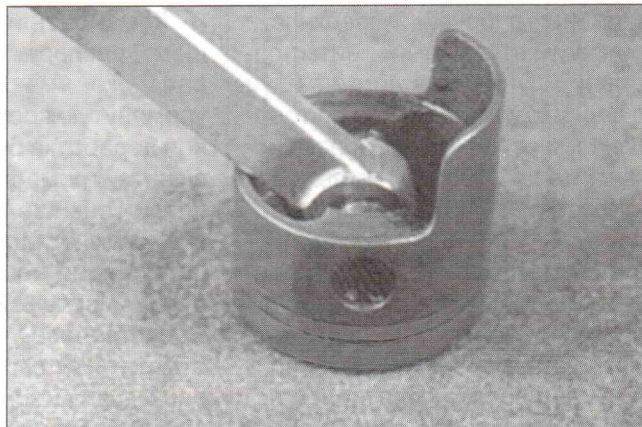
Доработанный поршень. Оставленная часть юбки закрывает выхлопное окно при положении поршня в верхней мертвой точке, остальная спилена до бобышек.
