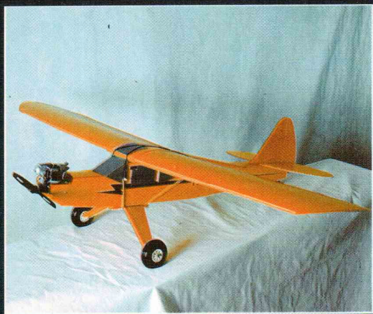
Тренировочный самолет Sub-40 от американской фирмы Air Core. Размах модели 1600 мм, масса до 3500 г. Модель рассчитана под микродвигатель объемом до 10 см 3 . В состав набора входят выкройки, вырезанные из «коропласта» и основные узлы.
