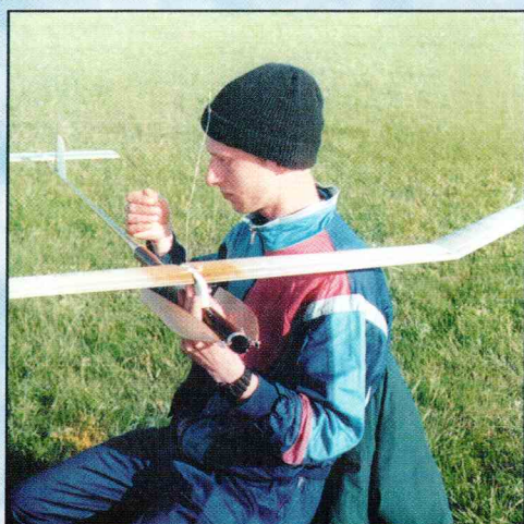
Владимир Мироненко готовится к запуску. Хорошо видна антенна радиомаяка — без этого прибора в такой ветер обойтись сложно.
