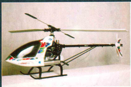
Вертолет Eagle-2EX японской фирмы Hiboro предназначен для спортсменов-профессионалов (с такой моделью выиграны чемпионаты мира 1997 и 1999 годов). Диаметр ротора 1,5 метра, полетная масса 4500 г. Модель поставляется в виде набора комплектных деталей и узлов.
