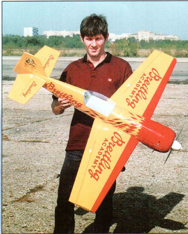
Любительская копия Су-26, собранная из набора фирмы Kyosho С.Шуваловым. Размах крыла 1380 мм, полетный вес 2800 г, мотор OS MAX .46-FX.
