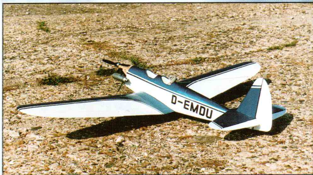
Миниатюрную любительскую копию авиетки 30-х годов Klemm-25 построил А.Крылов из набора фирмы Irvine. Размах крыла равен 1100 мм, полетный вес 970 г, двигатель OS MAX .15-LA.
