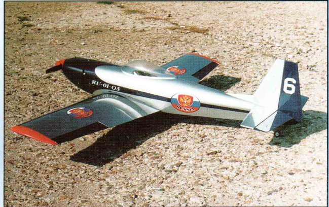
Оригинальная «копия» любительского самолета, разработанная и построенная заслуженным московским моделистом Львом Алешиным. При размахе крыла 1500 мм его площадь составляет 37,5 дм 2 , полетный вес равен 2500 г, двигатель Irvine-46.
