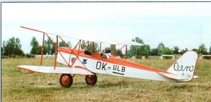
Сборная команда Кишинева по RC моделям на открытом Кубке «Аэрос» (2001 год, город Киев). Слева направо И.Берекет, Б.Ион, А.Алексий. На отдельном снимке копия чешского самолета AERO-34 «KOS» (масштаб 1:5,5, размах 1550 мм, вес 3800 г, двигатель МДС-6,5), с которой Игорь Берекет занял третье место. Кстати он же автор интересного материала, опубликованного в предыдущем номере журнала.
