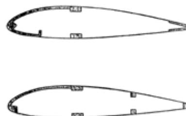
Рис. 10. Различия в двухлонжеронной; 2 — ребро; 3 — однолонжерон
