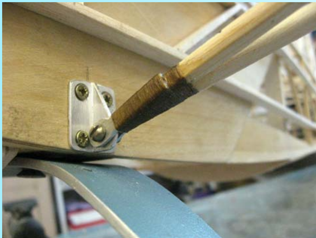
Крепление низа подкоса к фюзеляжу.
