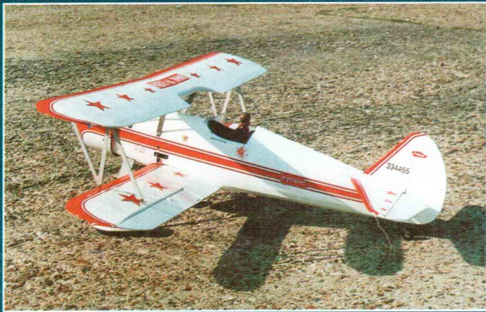
Пилотажный PT-17 Super-Stearman японской фирмы Kyosho собран Дмитрием Эйхнером. Модель размахом 1260 мм оснащена четырехтактным двигателем Yamada-63. Полный вес RC-биплана равен 2900 г.
