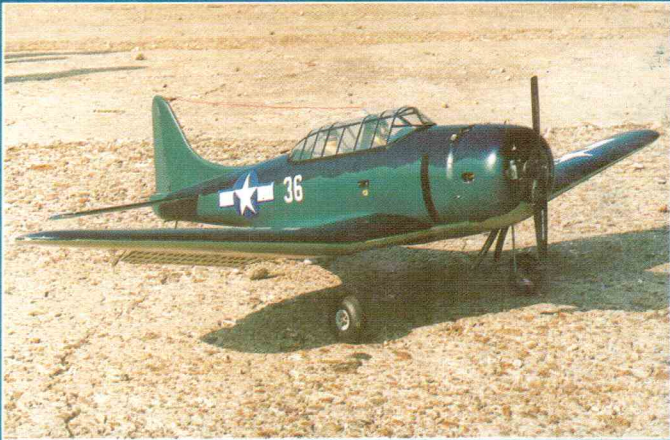
Солидно смотрится копия американского многоцелевого самолета SBD-3 «Dauntless», построенная В.Гуровым из набора фирмы Heritage. Размах крыла равен 1450 мм, а вес модели составляет около 3500 г. Установлен отечественный МДС-48, управление RB-6000 Sanwa.
