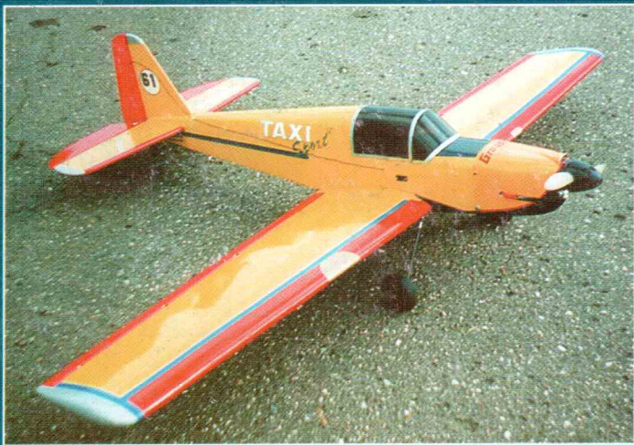
RC модель TAXI (Graupner) подмосковного спортсмена А.Марулина. Модель размахом 1500 мм и взлетной массой 2600 г снабжена двигателем МДС-40.
