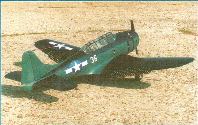
Солидно смотрится копия американского многоцелевого самолета SBD-3 «Dauntless», построенная В.Гуровым из набора фирмы Heritage. Размах крыла равен 1450 мм, а вес модели составляет около 3500 г. Установлен отечественный МДС-48, управление RB-6000 Sanwa.
