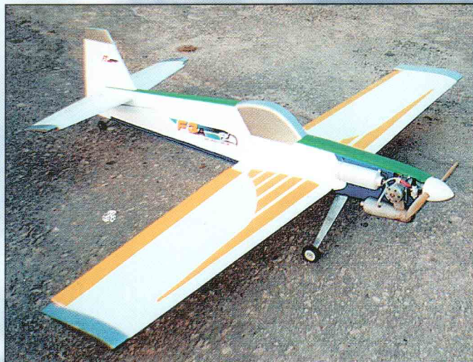
Размах 1640 мм, двигатель МДС-68 — и полный вес всего 1900 г. Такова модель пилотажного типа, созданная Н.Буковым (страницы 12-15).
