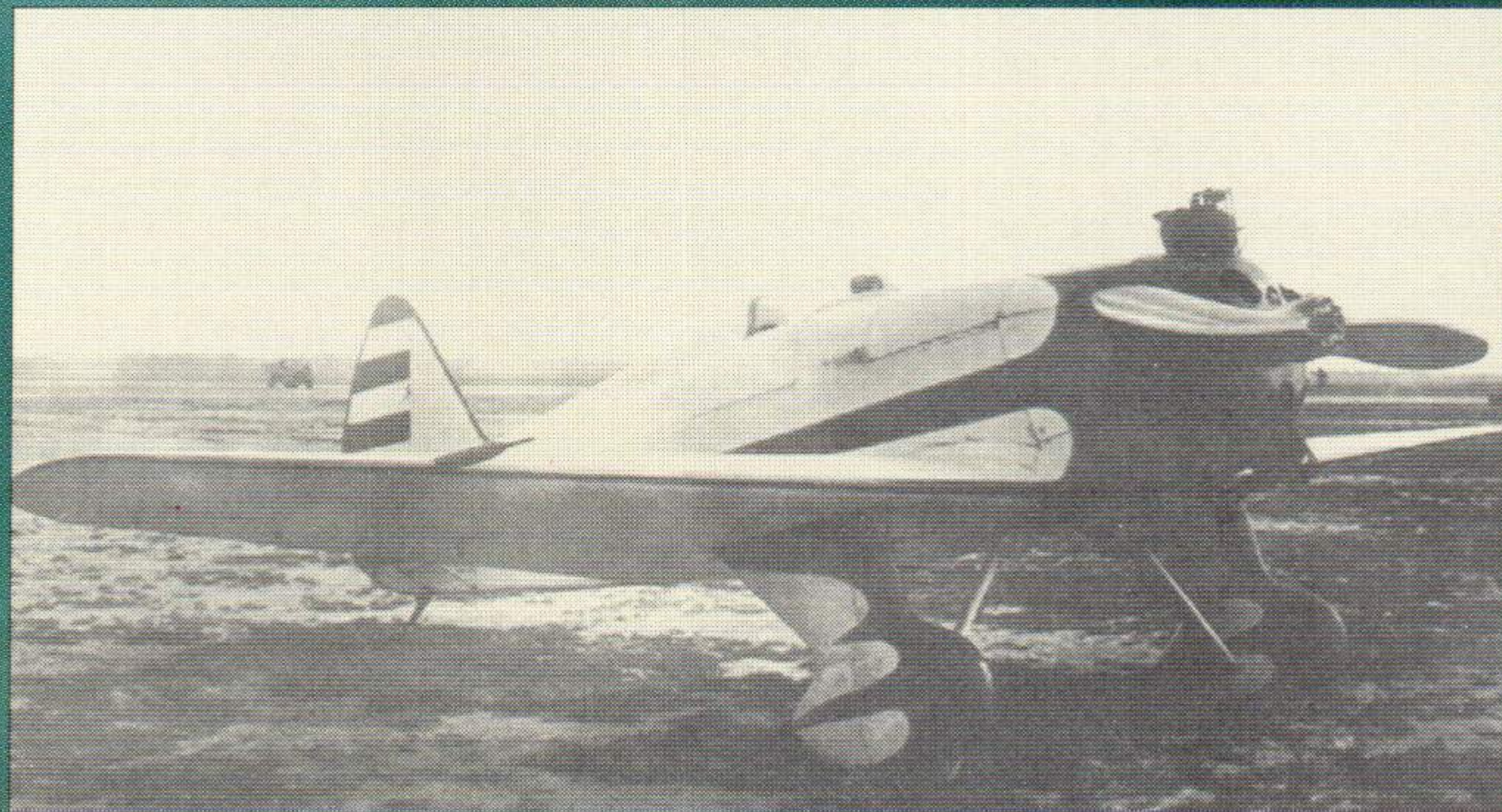
Самолет УТ-1 с двигателем М-11Е. Окраска стандартная. Отличие лишь в утолщенной трубке заборника воздушного давления на правой консоли крыла. Снимок сделан в 1937 году.
