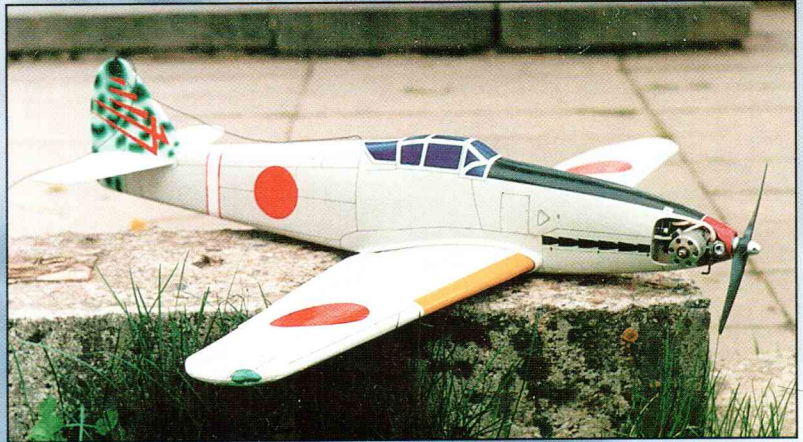
Полукопия японского истребителя KI-61. Размах модели 1040 мм, длина 760 мм, вес 790 г. Установлены две рулевые машинки HS-422. Отделка — нитрокраска, паркетный лак и фрагменты из цветной пленки. Расшивка выполнена тушью.
