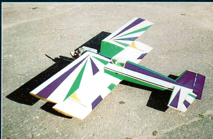
Крыло типа «чайка» не часто встретишь на моделях. Такую необычную схему выбрал для своего радиоуправляемого биплана Н.Буков. Модель оборудована двигателем МДС-68 и весит 2800 г.
