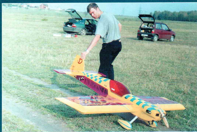
Александр Селезень буксирует к месту старта крупномасштабную модель Diablotin XXL, собранную из набора известной чешской фирмы и оснащённую новым бензиновым двигателем ZDZ-40 RV. Несмотря на солидные габариты и вес, схема самолёта типа «фан-флай», позволяет выполнять пилотажный комплекс с завидной лёгкостью.
