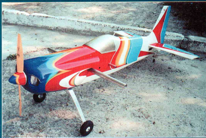
Радиоуправляемая пилотажная модель класса F3A-X, разработана и создана известным авиамodelистом из г. Ярославля Алексеем Герасимовым, под бензиновый двигатель объёмом 62 см 3 . Размах крыла составляет 2400 мм, полётный вес до 8300 г, применяется фирменный деревянный воздушный винт 560×255 мм.
