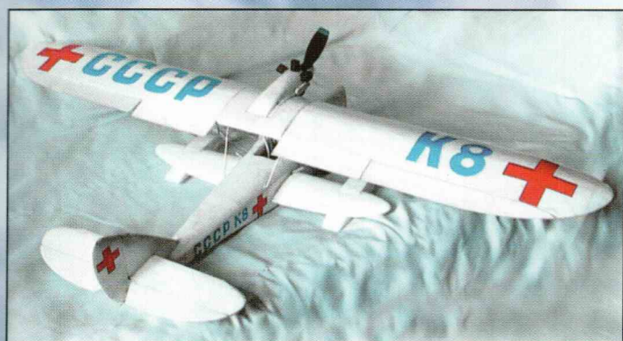
Модель-копия отечественного самолета Ш-2 подкласса Park-Flyer . Размах модели равен 960 мм, полный вес 400 г.
