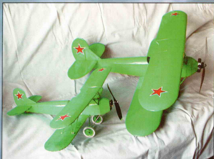
Две модели-копии отечественного самолета По-2 подкласса Park-Flyer (размах 920 мм, вес 420 г) и подкласса Slow-Flyer (размах 545 мм, вес 186 г).
