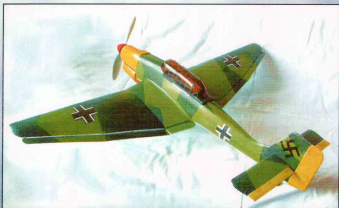
Модель-копия немецкого самолета Ju-87B подкласса Park-Flyer . Размах модели равен 920 мм, полный вес 420 г.
