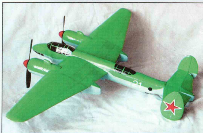
Модель-копия отечественного самолета Ту-2 подкласса Park-Flyer . Размах модели равен 885 мм, полный вес 405 г.
