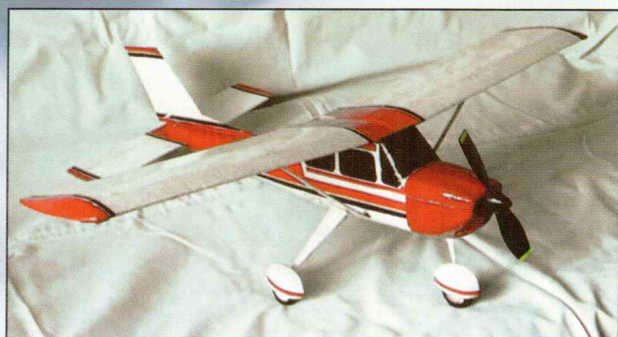
Модель-копия американского самолета Cessna-177 подкласса Slow-Flyer . Размах модели равен 720 мм, полный вес 230 г.
