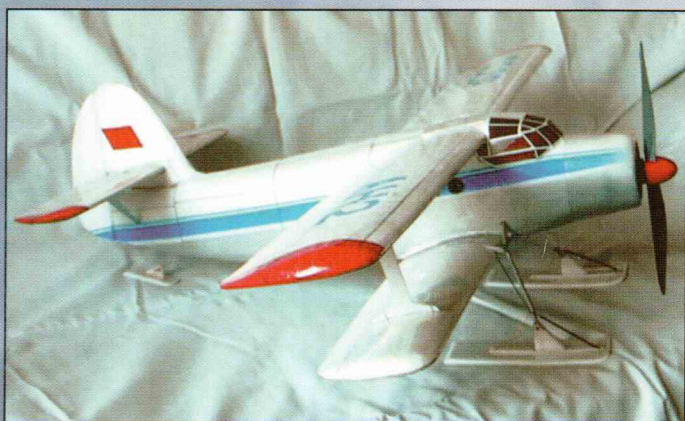
Модель-копия отечественного самолета Ан-2 подкласса Park-Flyer . Размах модели равен 860 мм, полный вес 400 г.
