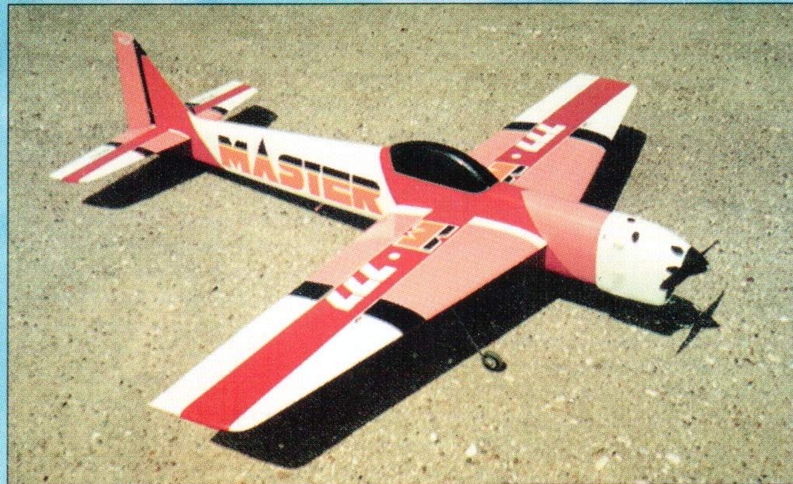
Модель бронзового призера Валерия Скворцова снабжена бензиновым двигателем объемом 19 см 3 собственной конструкции. Масса самолета равна 4950 г.
