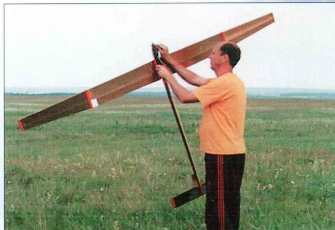
Стартует А.Толкнов с таймерной моделью класса F1C собственной конструкции, оснащенной закрылком по всему размаху крыла.
