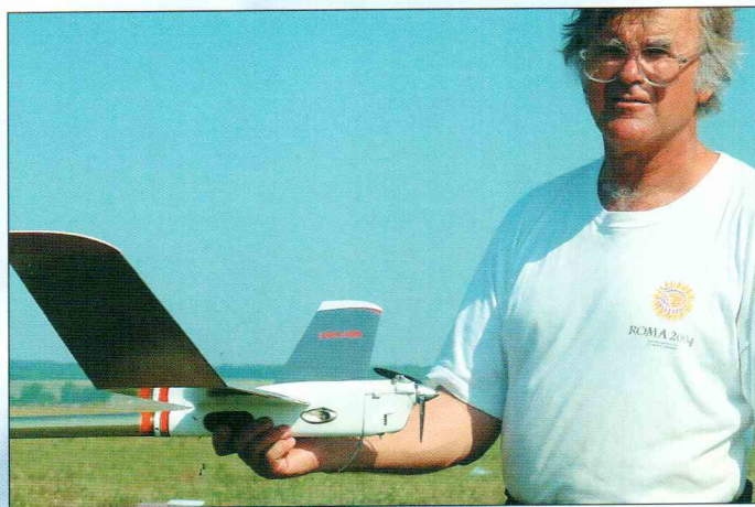
Оригинальная носовая часть таймерной модели Анатолия Кислюковского. Это решение возникло в результате установки на модель самодельного таймерного мотора чемпионатного класса, разработанного и изготовленного московским авиамodelистом М.Журавлевым.
