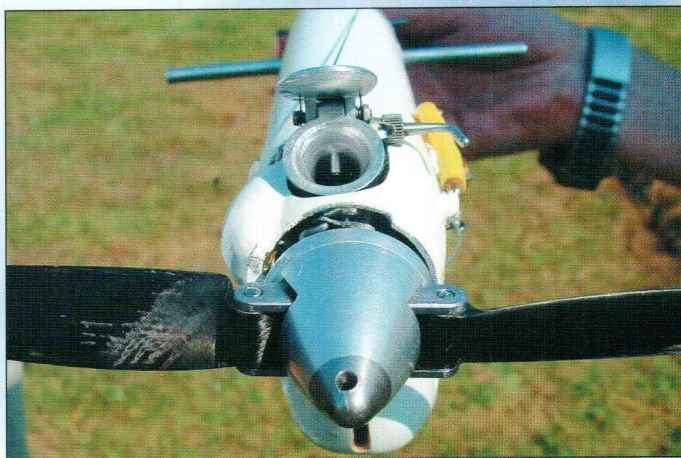
Оригинальная носовая часть таймерной модели Анатолия Кислюковского. Это решение возникло в результате установки на модель самодельного таймерного мотора чемпионатного класса, разработанного и изготовленного московским авиамodelистом М.Журавлевым.
