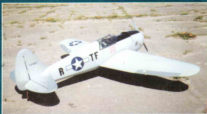
Копия истребителя Thunderbolt Алексея Перфильева. Модель собрана из набора фирмы Global (состояние поставки ARF). Размах крыла 1450 мм, вес 3050 г. Двигатель МДС-10 см 3 .
