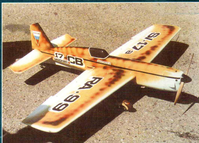
Кордовый «суперакробат» класса F2B МСМК Виктора Саленка. Модель оснащена самодельным двигателем и, так же, как техника его брата Валентина Саленка, имеет разборную конструкцию.
