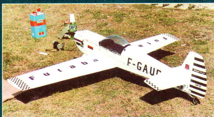
Упрощенная копия самолета CAP-21 Максима Боярова. Размах крыла около 1800 мм, вес до 4700 г, двигатель двухтактный, объемом 23 см 3 , с искровым зажиганием.
