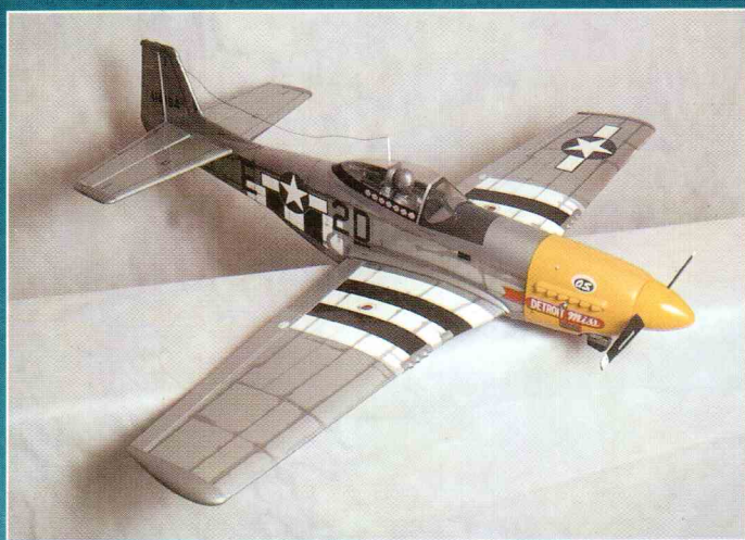
Копия истребителя P-51D «Мустанг», выпускаемая японской фирмой EZ (набор класса ARF). Размах крыла 1420 мм, масса около 3000 г. Двигатель — двухтактный, объемом 6,5-8 см 3 , или четырехтактный до 15 см 3 .
