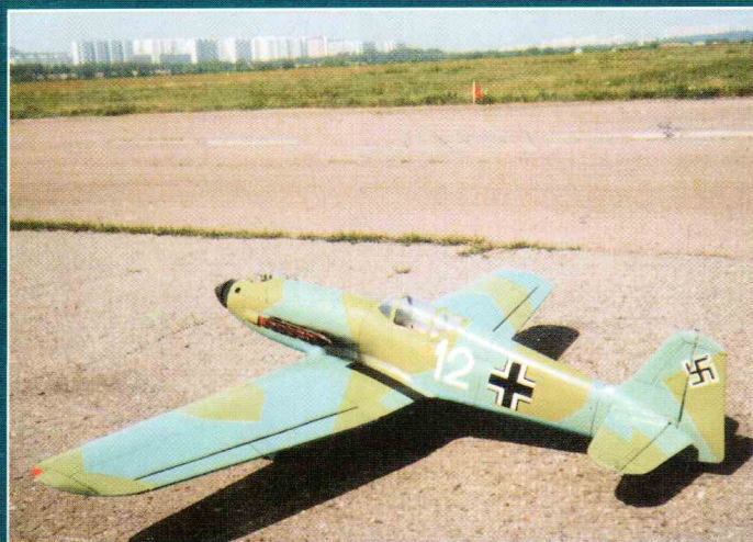
Полукопия немецкого истребителя Heinkel-100 спроектирована и построена Сергеем Корсаковым. Технические данные модели: размах 1360 мм, вес 3800 г, двигатель — «Радуга-7». Конструкция бальзовая.
