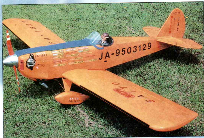
Стилизованная под спортивную авиетку демонстрационная модель японских модельистов-испытателей фирмы Saito. Размах крыла 2040 мм, полетная масса 6000 г, управление осуществляется по шести каналам из которых 2 канала отведено на контроль оригинального четырехтактного двигателя FA-182T-D. Мотор изготовлен по наисовременнейшим технологиям, головки выполнены в виде моноблоков ААС. Каждый цилиндр оборудован своим карбюратором и системой регулируемого в полете подкала свечи. С винтом APC 406×230 мм двигатель развивает 9200 об/мин.
