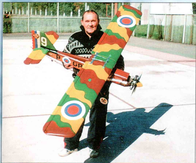
КМС Анатолий Боков из г. Железногорска Курской области с созданной им оригинальной радиоуправляемой моделью самолета в стиле «ретро», для показательно-развлекательных полетов. Размах крыла 2200 мм, полетный вес около 5000 г, мотор «Радуга-10», дистанционное управление японской фирмы Futaba.
