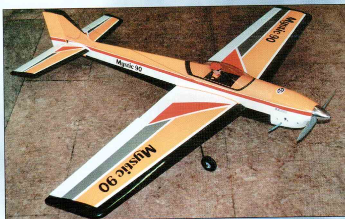
Спортивная пилотажная модель австрийского спортсмена Ханно Преттнера Mystic 90 в исполнении известной японской фирмы EZ. Самолет поставляется в виде набора ARF и имеет оригинальную запатентованную конструкцию. Размах крыла 1600 мм, длина фюзеляжа 1400 мм, полетная масса всего 2930 г! Двигатель OS MAX 91 FX.
