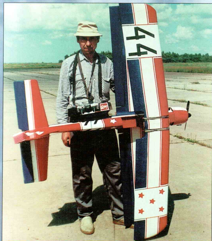
Мастер спорта, Чемпион России 1997 года в классе F4C, Владимир Шибаев из г. Курска с изготовленным радиоуправляемым бипланом произвольной конструкции. Размах крыла модели 2300 мм, масса 6000 г, микродвигатель «Радуга-10» с самодельным редуктором. Система радиоуправления Futaba.
