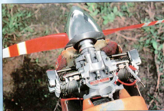
Стилизованная под спортивную авиетку демонстрационная модель японских модельистов-испытателей фирмы Saito. Размах крыла 2040 мм, полетная масса 6000 г, управление осуществляется по шести каналам из которых 2 канала отведено на контроль оригинального четырехтактного двигателя FA-182T-D. Мотор изготовлен по наисовременнейшим технологиям, головки выполнены в виде моноблоков ААС. Каждый цилиндр оборудован своим карбюратором и системой регулируемого в полете подкала свечи. С винтом APC 406×230 мм двигатель развивает 9200 об/мин.
