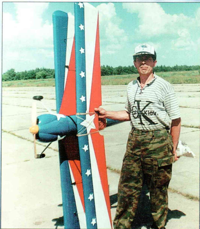
КМС Юрий Маслов из г. Курска с построенным им радиоуправляемым пилотажным бипланом свободного класса. Размах крыла составляет 2400 мм, полетный вес около 6000 г, микродвигатель венгерского производства «Moki-10» с понижающим редуктором. Аппаратура управления Futaba.
