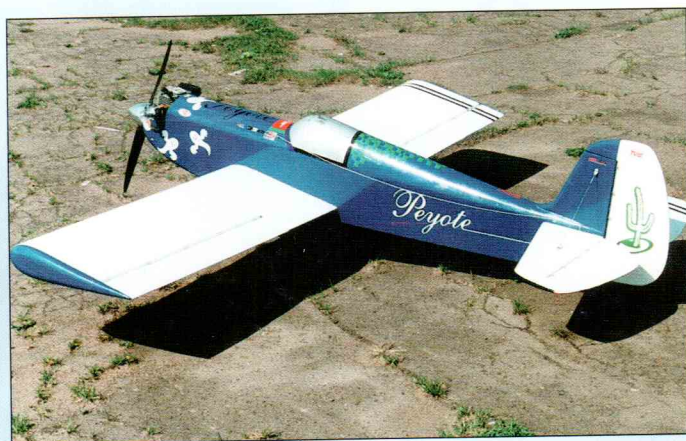
Пилотажная модель свободного класса Peayote сконструирована и изготовлена московским модельистом Максимом Бояровым. Размах крыла составляет 2100 мм, полетный вес около 7000 г, установлен бензиновый двигатель с искровым зажиганием японской фирмы Zenohh объемом 62 см 3 . Для улучшения характеристик мотора Максим успешно доработал впускной диффузор карбюратора.
