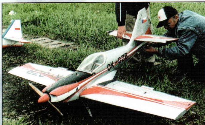
Модель бронзового призера соревнований В.Журавля — одна из лучших на этом чемпионате как по качеству изготовления, так и по летным данным. Двигатель объемом около 20 см 3 .
