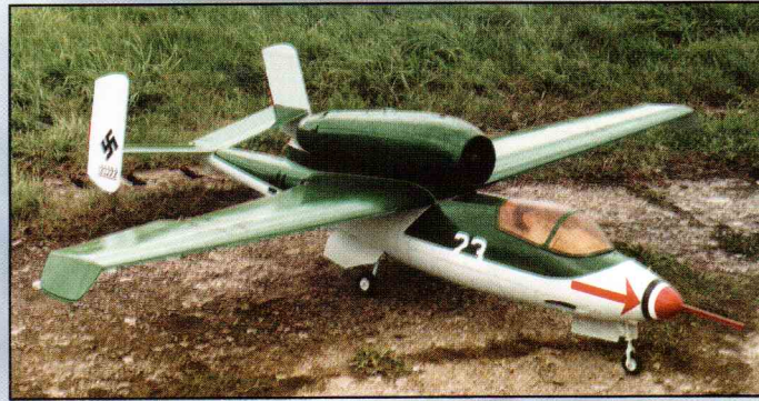
Уникальная модель экспериментального реактивного самолета Хейнкель-162 «Саламандра» создана В.Громковым. Копия оснащена импеллерной установкой американской фирмы Дунатах, позволяющей продемонстрировать реалистичный «реактивный» полет.
