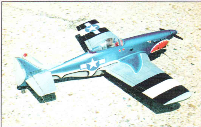
Полностью самодельную копию американского истребителя P-51D Mustang представил Ренат Бигельдин. Модель оснащена четырехтактным двигателем OS MAX 70-FS и системой уборки шасси. Размах крыла составляет 1500 мм, вес около 3500 г.
