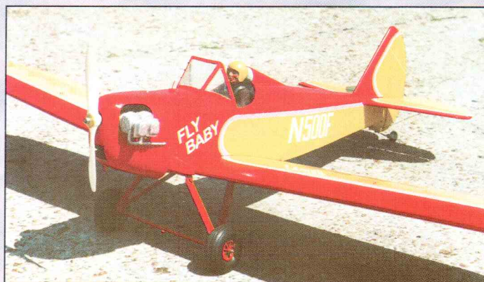
Модель-копия авиетки Fly Baby построена руководителем кружка авиамоделизма Геннадием Кошкиным. Размах крыла 1750 мм, длина 1200 мм, масса 3200 г, двигатель МДС-6,5.
