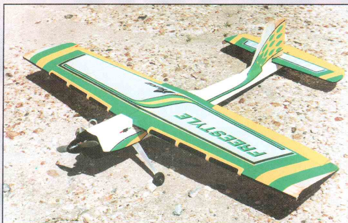
Пилотажно-тренировочная модель Freestyle, созданная Леонидом Калининым. Размах крыла 1400 мм, длина модели 1210 мм, масса 2200 г, двигатель МДС-6,5, аппаратура Hitec Focus-6. Обтяжка — астролон, отделка — широкий разноцветный скотч.
