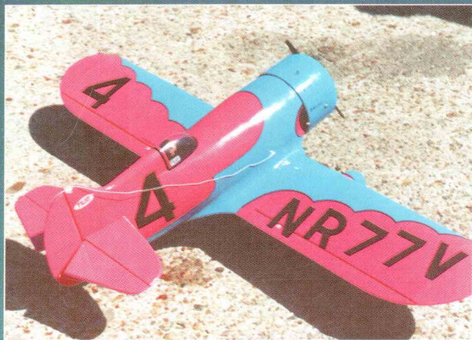
Любительская копия гоночного самолета Gee-Вее Андрея Гриневича. Размах крыла 1400 мм, вес около 2300 г, двигатель OS MAX 46-LA. В постройке модели активное участие принимал Михаил Авсеньев.
