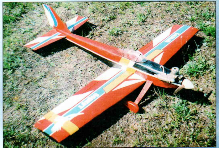
Пилотажная модель «Белый беркут» Бориса Адамова, напоминает классическую «Квикфлай-3». Размах крыла 1150 мм, длина фюзеляжа 1130 мм, масса примерно 3200 г, микродвигатель «Радуга-10 Р».
