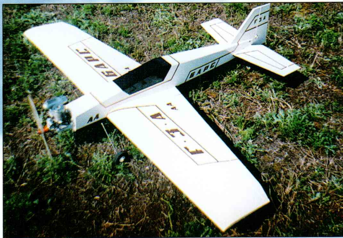
Спортивно-тренировочная модель «Барс» спортсмена Андрея Алисова, занявшего второе место. Размах крыла модели 1300 мм, габаритная длина 1200 мм, масса около 2700 г, двигатель «Радуга-10 Р».
