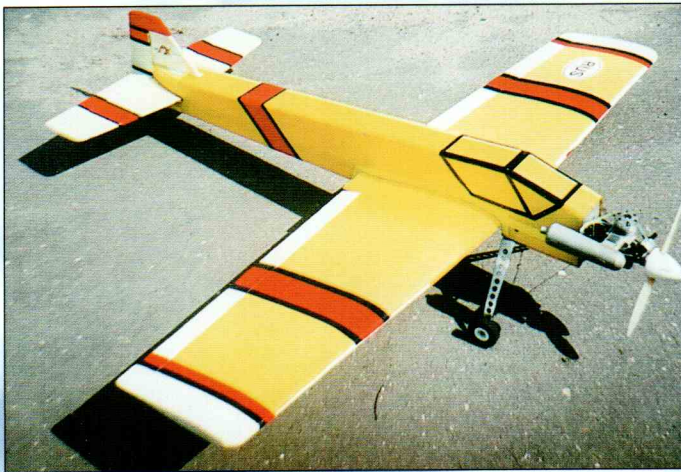
Модель победителя соревнований Дмитрия Чернова (команда Чехов-2). Размах крыла 1450 мм, габаритная длина 1400 мм, масса около 2700 г, двигатель МДС-58 КУ. Фюзеляж модели выполнен из гофропласта.
