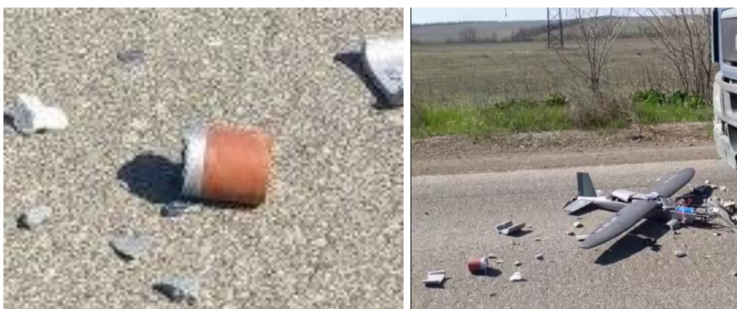
Рисунок 14 Осколочно-фугасная БЧ. Вероятно, является суббоеприпасом.
