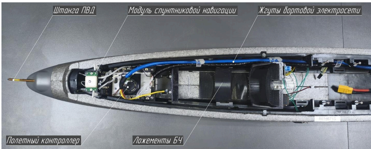
Рисунок 2 Отсек БР90 эксплуатационного люка БПЛА «Хорнет».
