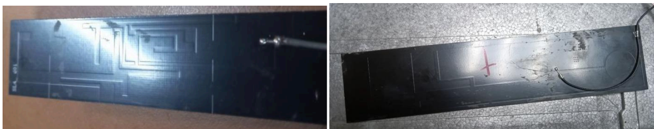
Рисунок 24 Как выглядит антенна канала управления и их согласование по сопротивлению и соответственно по КСВ: слева 169МГц, справа 470МГц
