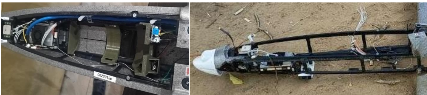
Рисунок 15 Примеры специальной рамки для БЧ УЯ-У-95-4. Для других БЧ обычное крепление к каркасу (бимсам) Изначально в продольных балках (бимсах) сделаны отверстия под пластиковые хомуты для крепления БЧ, но пришлось делать ложемент, чтобы тяжёлая БЧ не болталась
