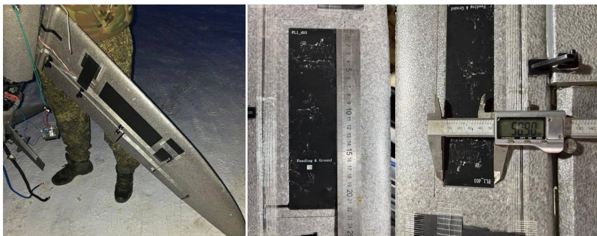
Рисунок 26 Расположение антенн канала управления по протоколу LoRa 169 МГц и 470 МГц
