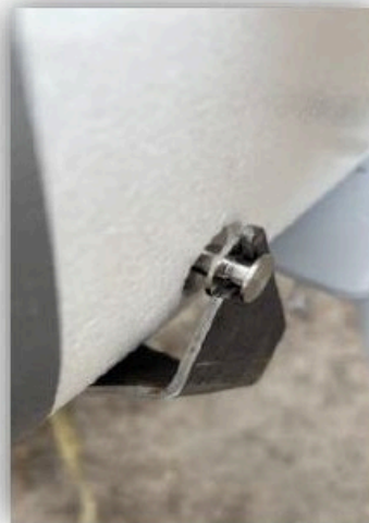
Общий вид опорного штифта фюзеляжа, вставленного в выемку вилки пускового поршня.
