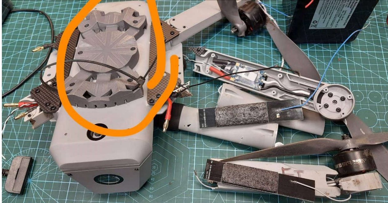
Вид с внешней планкой крепления БЧ. Отдельно показаны печатные антенны, ESC, моторы.
