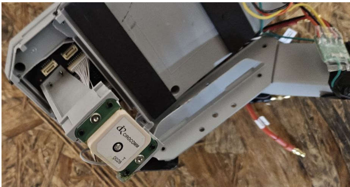
Общий вид с антенной ГНСС диапазона L1 и справа вверху видна плата инициации БЧ
