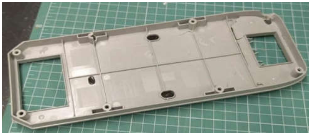
Верхняя пластиковая крышка из пластика PA+55%GF. Тип пластика указан на штампе.
